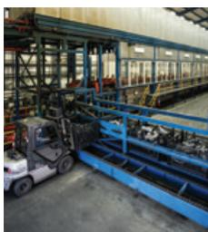
El recubrimiento Ecoat (electroforesis) de Charlotte Pipe es un proceso extremadamente eficaz para la aplicación de revestimiento sobre una superficie metálica. Las conexiones y las tuberías de cinco pies (3.05 mt) de largo se envían a través de un proceso de quince etapas, incluyendo etapas múltiples de limpieza, seguido por la aplicación de una capa a base de fosfato de zinc y luego dos etapas en donde
