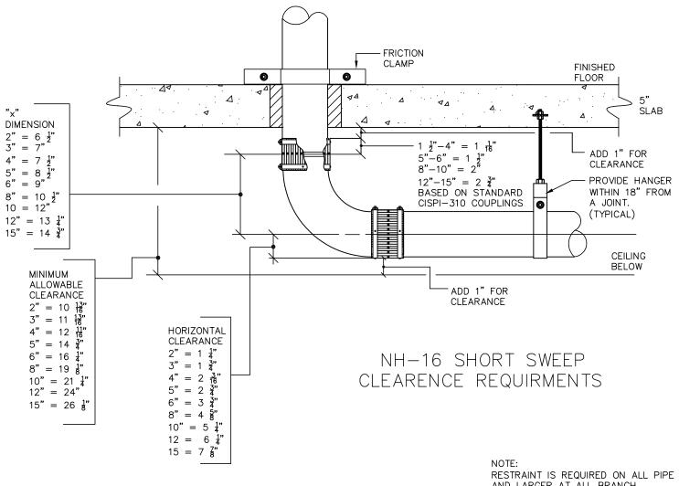
RESTRAINT IS REQUIRED ON ALL PIPE 5"
