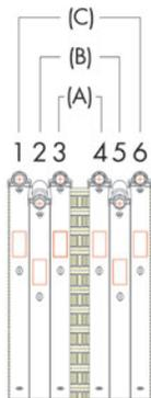
Nota: Cuando haya una diferencia visiblemente notoria en el D.E. (Diámetro Exterior) entre la tubería y la conexión se recomienda el siguiente patrón de torque; 1-4, 2-5 y 3-6.
