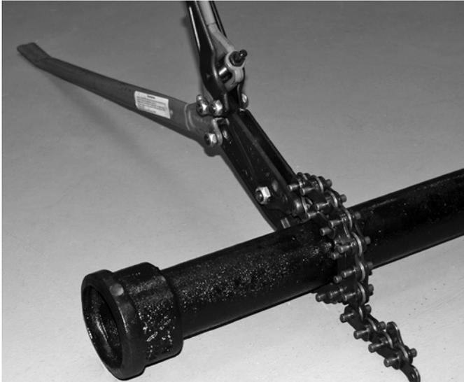
4. Marque la tubería aplicando presión sobre las palancas, que hacen que las ruedas de corte dejen una serie de muescas sobre la superficie de la tubería. Marcar la tubería antes de cortarla es la clave para obtener un corte recto y limpio. Si una tubería es inusualmente más dura, haga en ella varias muescas antes de hacer el corte final.
