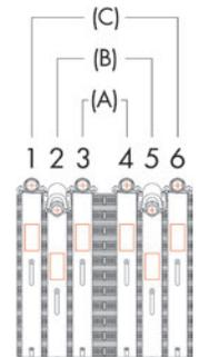
Nota: Cuando haya una diferencia visiblemente notoria en el D.E. (Diámetro Exterior) entre la tubería y la conexión se recomienda el siguiente patrón de torque; 1-4, 2-5 y 3-6.
