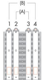
Nota: Cuando haya una diferencia visiblemente notoria en el D.E. (Diámetro Exterior) entre la tubería y la conexión se recomienda el siguiente patrón de torque; 1-3 y 2-4.
