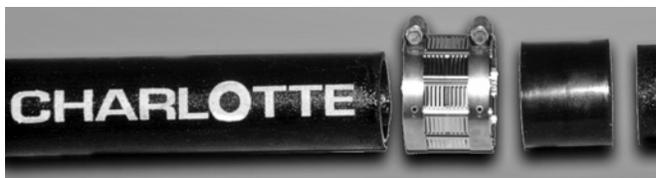
1. Coloque los componentes como se muestra. Cortar los extremos de la tubería en escuadra y tan suavemente como sea posible. Compruebe que el cople y el empaque estén libres de material extraño, limpie si es necesario.
